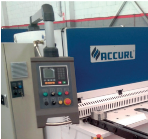
Posicionador de la medida del tope modelo ESTUN E21s con memoria y cuenta piezas.
